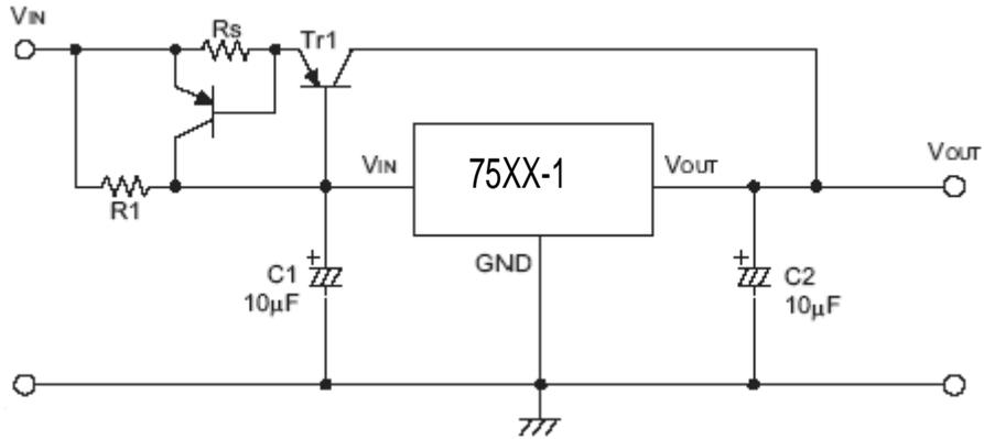
4、 提高输出电压电路(1)
